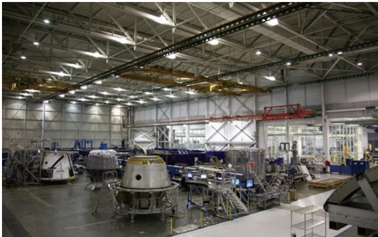
El traslado de SpaceX a una nueva fábrica en Hawthorne (California) le permitió ampliar la cadena de montaje para trabajar en la construcción de varios cohetes y cápsulas al mismo tiempo. © Steve Jurvetson
