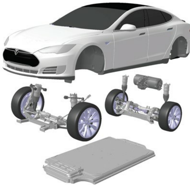
La berlina Modelo S de Tesla, con el motor eléctrico (cerca de la parte trasera) y la batería (abajo) a la vista. Fotografía cortesía de Tesla Motors.
