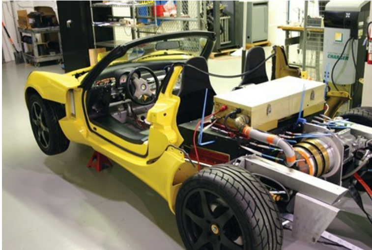
Un puñado de ingenieros construyó el primer Tesla Roadster en un almacén de Silicon Valley reconvertido en taller mecánico y laboratorio de investigación. Fotografía cortesía de Tesla Motors
